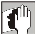
Avant de pulvériser l'apprêt, la surface traitée doit être dépoussiérée et dégraissée à l'aide du dissolvant APP W900 ou APP WB9010.
