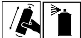
Bien mélanger l'apprêt en agitant le récipient pendant 2 à 3 minutes à une température de 15 à 25 °C. Effectuer un essai de pulvérisation. Appliquer l'apprêt uniformément sur la surface à isoler à une distance de 15 à 20 cm.
